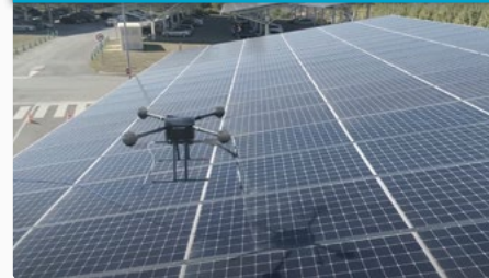
Reinigung von Solarfeldern
